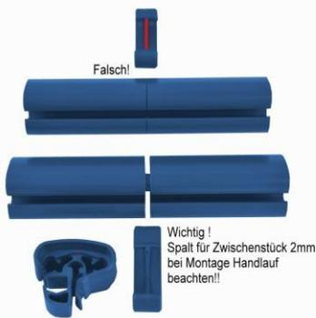
Innenhüllen falten in der Seitenwand durch seitliches Verschieben der Innenhülle korrigieren. Bei gutem Sitz Handlauf durch Schläge mit der flachen Hand oder mit einem Gummihammer komplett aufdrücken. **Achtung: unbedingt kontrollieren ob das Becken absolut in der Waagrechten steht.**
